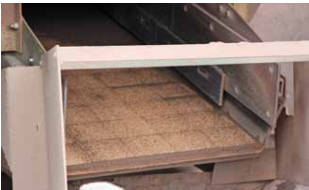
3 Eingebaute Kacheln nach mehrwöchigem Betrieb Installed tiles after several weeks of operation
