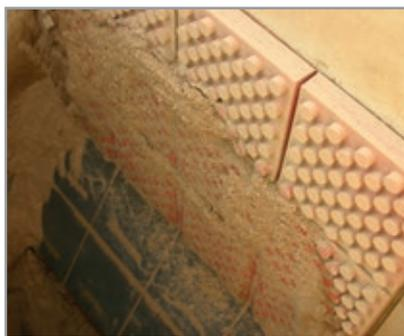
Die Kacheln am Tag des Einbaus. Vier Monate später sind Verschleißspuren sichtbar, allerdings im Verschleißgrad stark heterogen. Im Zuge des weiteren Verschleißes können einzelne Platten noch gedreht werden und nur wenige müssen komplett ersetzt werden.
